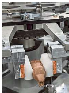
Auf einem Drehteller werden die Hasen in Folie eingeschlagen.
